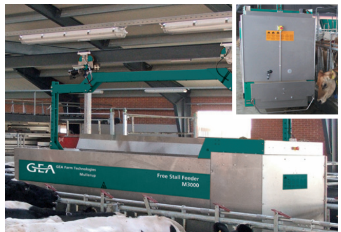
Fleißiger Energielieferant: Der computergesteuerte, batteriebetriebene Futterwagen serviert das Kraftfutter gruppenweise.
